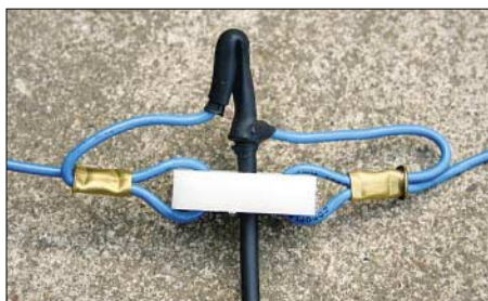
Die beiden Dipolhälften sind direkt mit dem Koaxialkabel verlötet. Ein Schrumpfschlauch schützt vor Feuchtigkeit.
