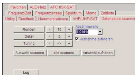
Ausgewählte Datenbankeinträge lassen sich automatisch per Kanalsuchlauf auf Aktivitäten checken. Eine Aufnahmefunktion dokumentiert Audiosignale.
