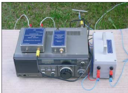
Bild 8: Beim Betrieb mit einer großen Schleifenantenne lassen sich durch die Erdung des Anpassverstärkers Schwingungen vermeiden. Der verwendete Einstecherder ist hinter dem Tisch zu erkennen. Fotos: DG9WF
