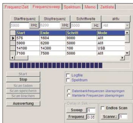
Der programmierbare Frequenzsuchlauf analysiert Bandbelegungen und zeigt Feldstärken.
