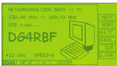
Bild 27: Displayanzeige während des Wobbels mit PC-Unterstützung
