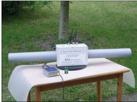
Bild 4: Antennenanpassverstärker mit UAP INAw kombiniert mit dem Super-Power-Ferri-modul der Firma BAZ; das 1 m lange, als Sonderfertigung mit einem Rohrdurchmesser von 7,5 cm und einem speziellen Wickelverfahren hergestellte Modul ist das bisher größte von BAZ gefertigte.
