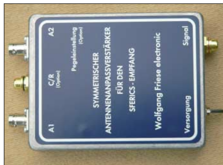
Bild 9: Symmetrischer Antennenanpassverstärker mit UAP INAw als Fertiggerät
