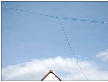
Wetterfest und unauffällig: Dierkings Dipol ist komplett montiert inklusive Antennenkabel und Stecker.
